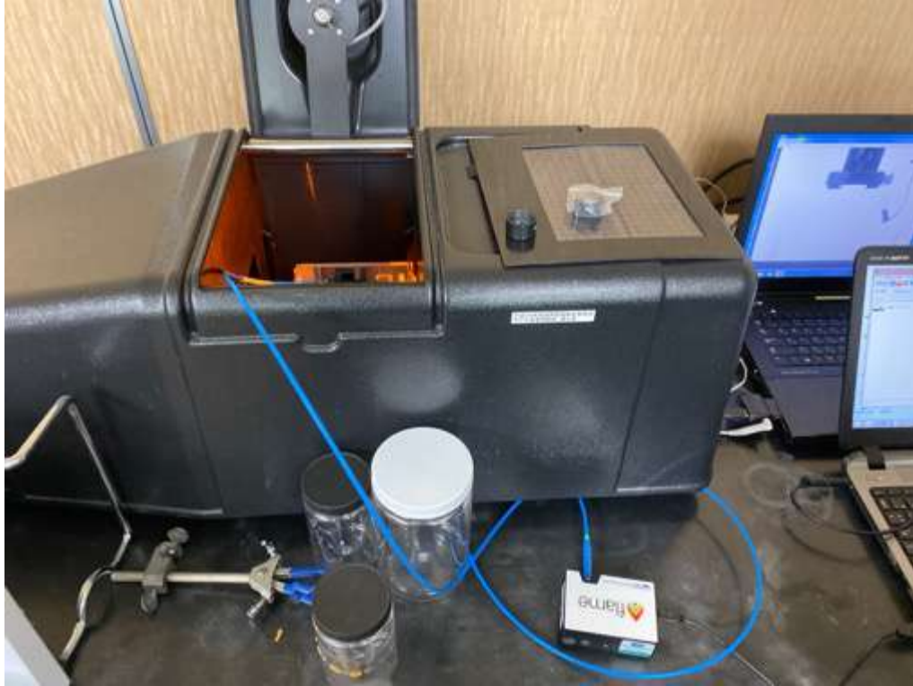
分光器 Ocean Optics社製 FLAME-S-UV-VIS を用いて測定波長を計測
